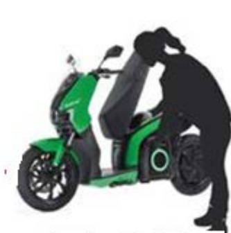
Tryck på spärrhaken Ta ur batteripaketet
